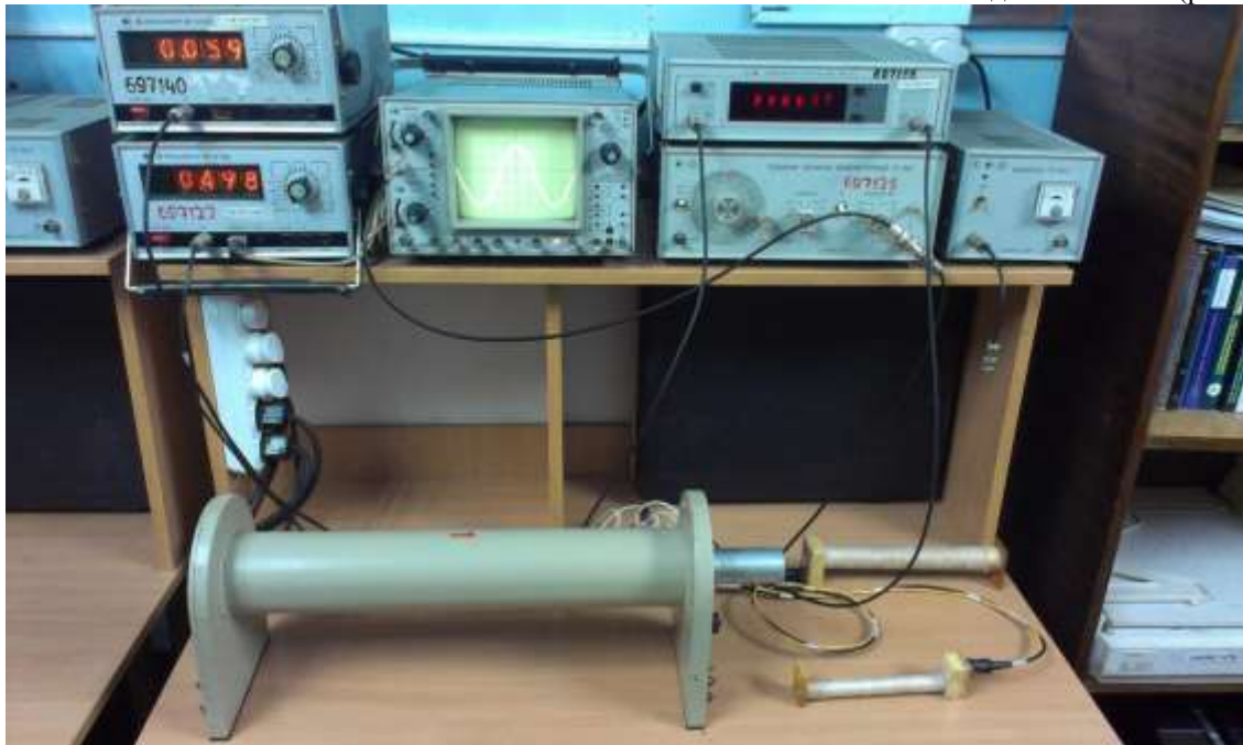
Рис. 1. Лабораторна установка для вимірювань впливу механічного зусилля в і температури на параметри проводів повітряних ліній
