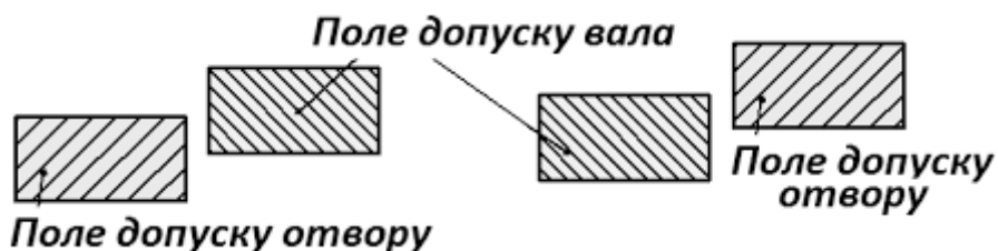
Рис. 23.2.4 – Схема утворення перехідної посадки
