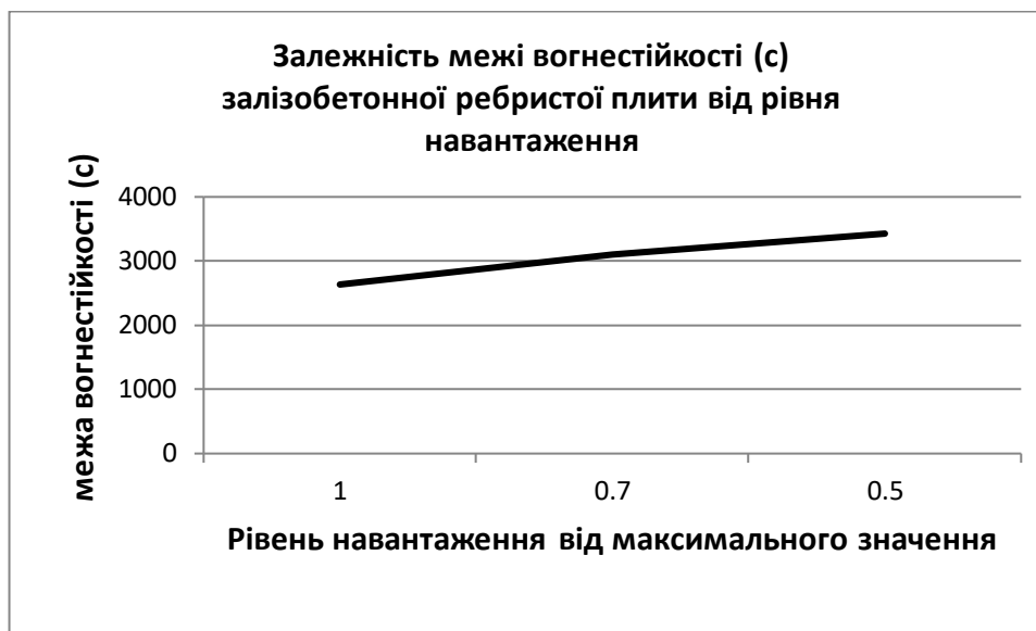
Рис. 7 – Залежність між показниками вогнестійкості та рівнем механічного навантаження залізобетонній ребристий плити.
