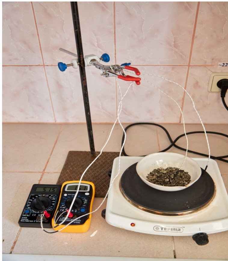
Рисунок 1. Установка для дослідження десорбції вогнегасячої солі з пор носія
