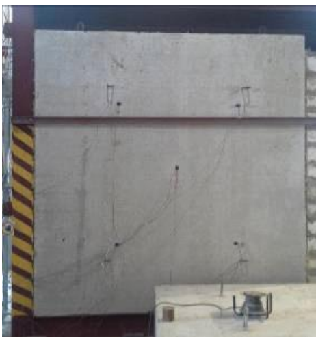
Рис. 5. Вигляд стінового фрагменту-зразку із залізобетону (а) та стінових фрагментів-зразків з блоків із легкого бетону (б).
