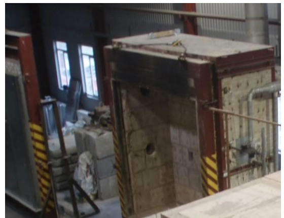
Рис. 3. Схема та зовнішній вигляд випробувальної установки для стандартних випробувань на вогнестійкість несучих стін.
