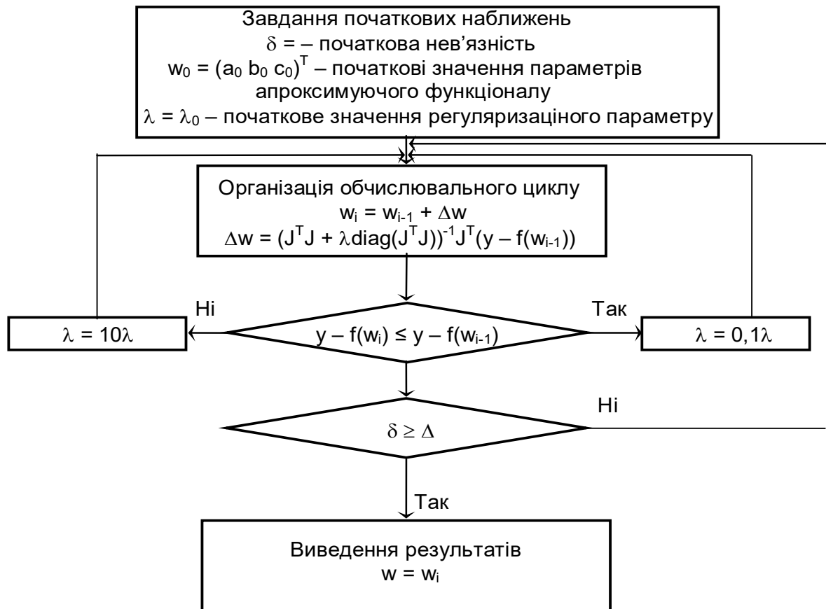
Рис. 2.13. Блок-схема алгоритму Левенберга – Марквардта визначення коефіцієнтів регресійної функції.
