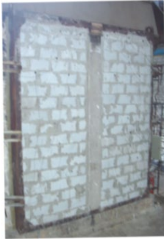
Рис. 3.13. Вигляд фрагменту стіни-зразку з блоків із легкого бетону для випробувань
