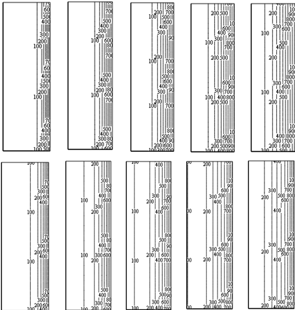
Рис. 2.3. Температурні розподілення у стінах товщиною 200 мм з керамічної цегли (а) та силікатної цегли (б).
