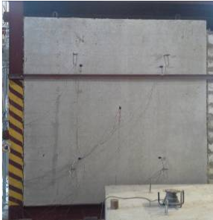
Рис. 3.9. Вигляд фрагменту залізобетонної стіни-зразку для випробувань
