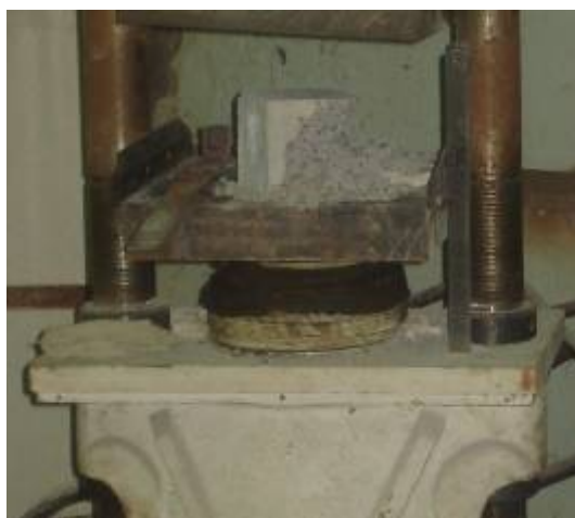
Рис. 4.1. Вигляд кубічного бетонного зразку після випробувань на міцність.
