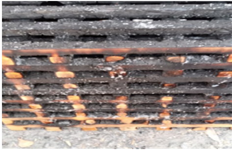
Рисунок 9 – Відкладання краплин гідрогелю та утворення полімерної плівки на поверхні модельного вогнища під час гасіння розчином гідрогелю
