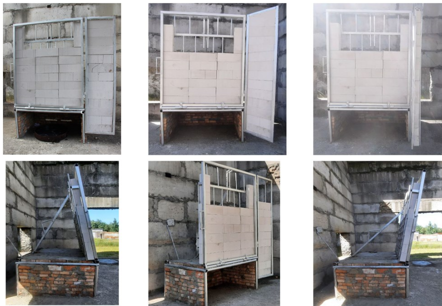
Рисунок 13 – Загальний вигляд виготовленого стенду та його конструктивні можливості трансформації
