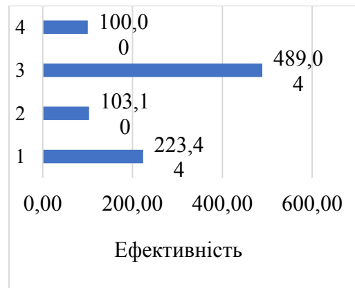
Рисунок 8 – Відносна ефективність ВВР під час ліквідації відкритого полум'я в перерахунку на модельне вогнище 2А відповідно до номера складу вогнегасної речовини
