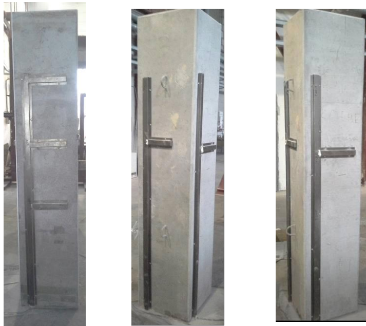
Рис. 3.9. Вигляд залізобетонних колон-зразків для випробувань
