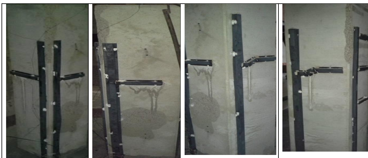
Рис. 4.2. Вигляд залізобетонної колони-зразку №2 з чотирьох боків після проведення вогневих випробувань
