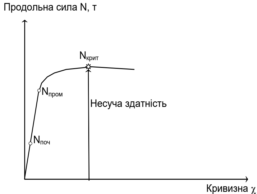
Рис. 1.15. Схема визначення критичної сили для залізобетонної колони у поточний момент часу дії пожежі.
