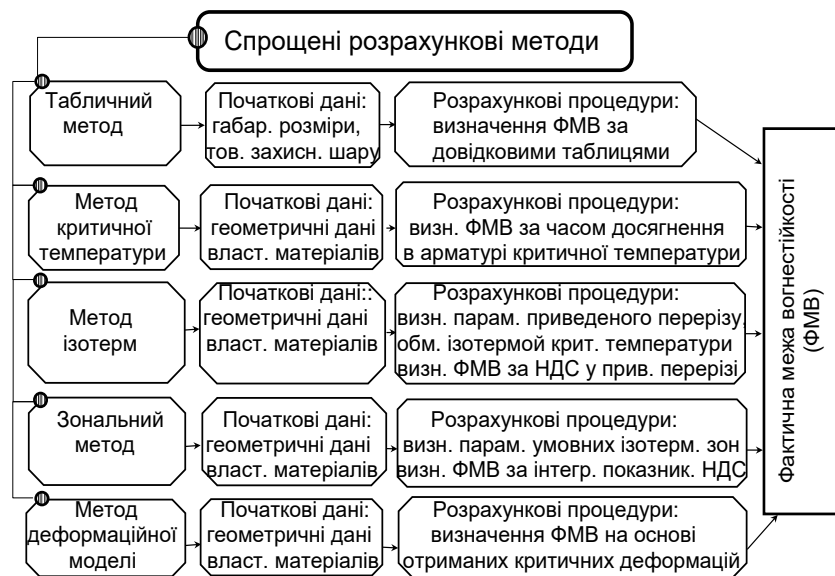
Рис. 1.5. Структурна схема спрощених розрахункових методів визначення вогнестійкості залізобетонних колон
