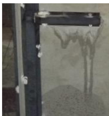
Рис. 4.3. Ушкодження колон-зразків після вогневих випробувань: а – тріщинувата структура поверхні; б – відколювання поверхні; в – сліди вологи, що випарилася крізь пори; г – локальні ушкодження поверхні
