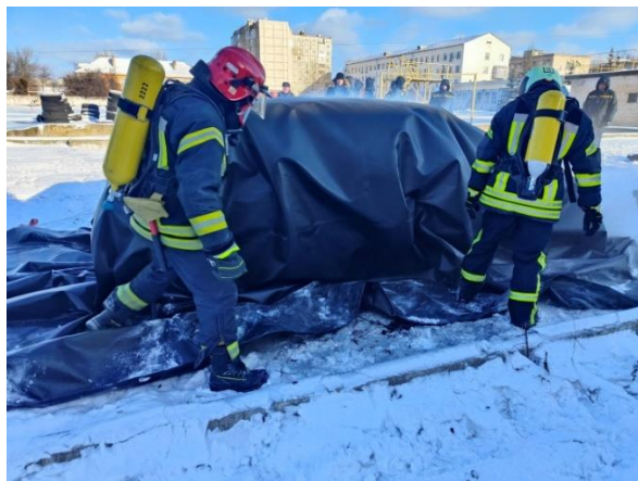
Рис. 2. Гасіння пожежі автомобіля ковдрою Bridgehill
