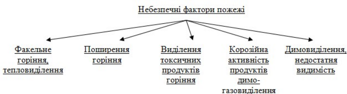
Рис. 2. – Небезпечні фактори пожежі в кабельному тунелі
