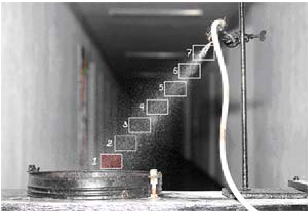
Рисунок 1 – Розподіл факелу розпилювача по зонам
