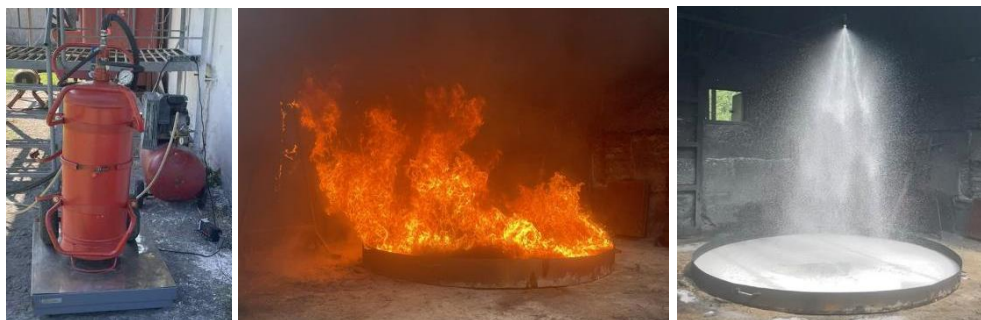
Рис. 1 Дослідний зразок з продукування КП та процес гасіння оливи на модельних вогнищах 183 В.
