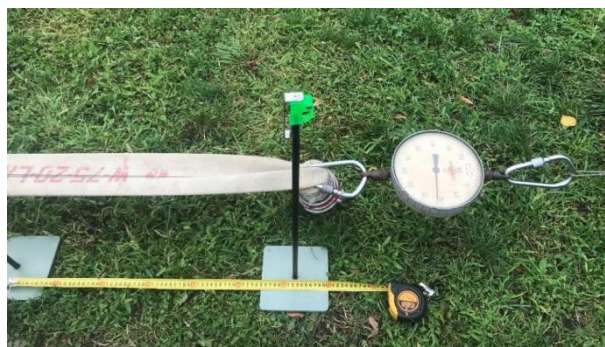
Рис. Проведення full-scale експерименту із застосуванням латексованих напірних пожежних рукавів довжиною 1960 см й діаметром D=77 мм
