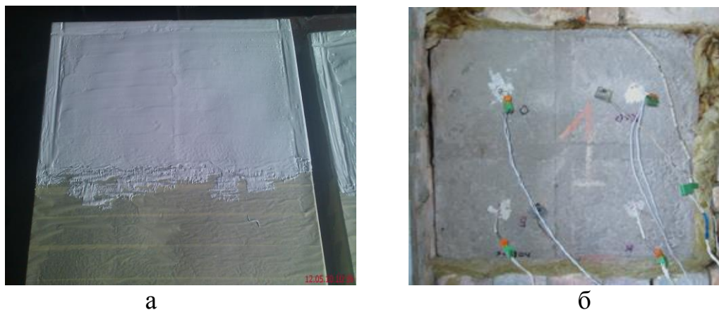
Рисунок 1 – Вид монолитного железобетонного перекрытия до испытания на огнестойкость: а) с обогреваемой поверхности; б) с необогреваемой поверхности.
