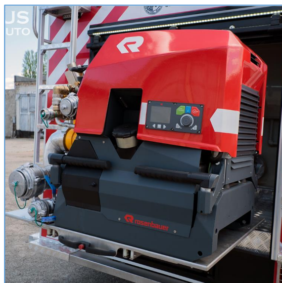
Рис. 2 – Пожежна мотопомпа від компанії Rosenbauer на висувній платформі
