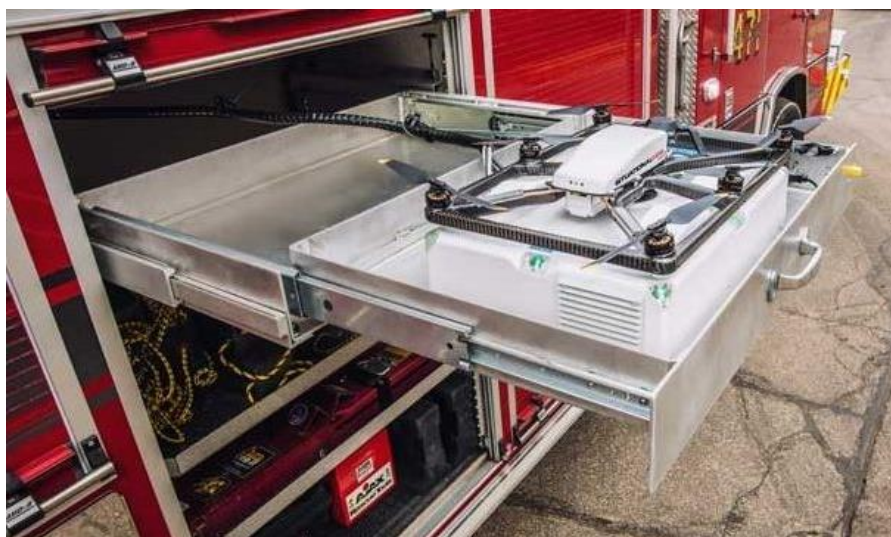
Рис. 1 – Вигляд БПЛА Pierce Fotokite в транспортному положенні
