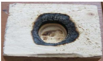
*Рис. 1. Вид термических поражений образца древесины*
