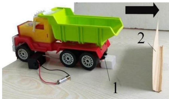
Рисунок 1 – Експериментальна установка: 1 – іонізатор; 2 – захисний екран
