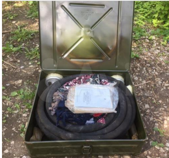
Рис. 1.2. Автомобільний комплект спеціальної обробки ДК-4.
