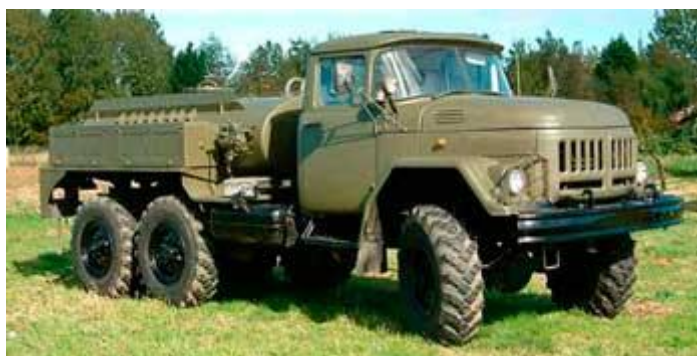
Рис. 4.9. Авторозливна станція АРС-14 Тактико-технічні характеристики станції
