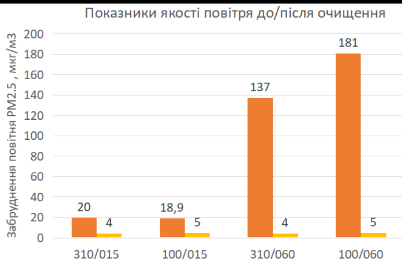
Рисунок 2. Показники повітрообміну для приміщення при використанні рециркуляційного агрегату з змінною витратою повітря з фільтрувальною вкладкою типу HEPA11 Потужність агрегату 100м 3 /годину та 310м 3 /годину.
