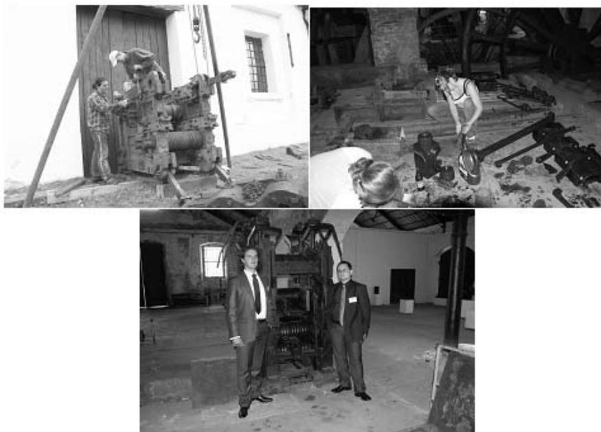
Rys. 12. Remont i konserwacja zabytkowej walcarki
