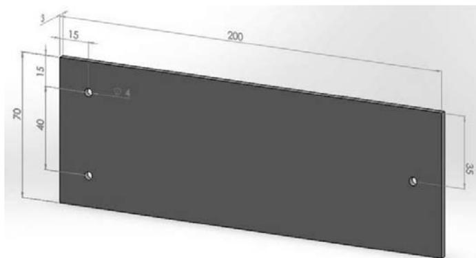
Рис. 1. Образец алюминиевой пластины
