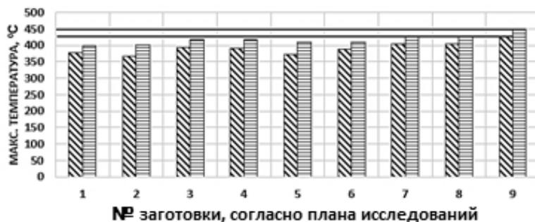
Рис. 8. Зависимость изменения максимальной температуры прессования ( $T_{max}$ ) при  $l=24$
