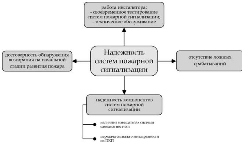
Рис. 1. Составные надежности систем пожарной сигнализации
