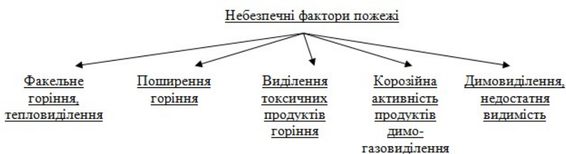
Рис. 2. – Небезпечні фактори пожежі в кабельному тунелі
