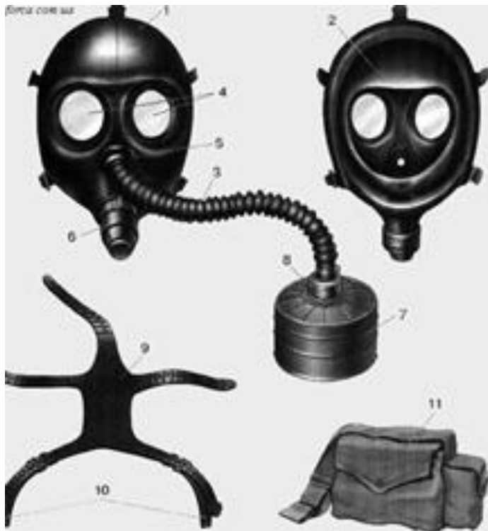
Рис. 3.19. – Протигаз дитячий фільтруючий шкільний ПДФ-2Ш: 1 – корпус; 2 – обтюратор; 3 – сполучна трубка; 4 – очковий вузол; 5 – вузол клапана вдиху; 6 – вузол клапана видиху; 7 – фільтрувальна коробка; 8 – накидна гайка; 9 – наголовник; 10 – гарантійні тасьми; 11 – сумка
