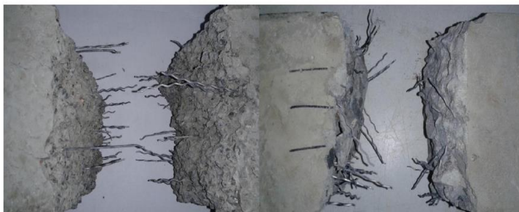
Рисунок 7.10 – Вигляд перерізу зруйнованого зразка із орієнтованою (а) та неорієнтованою (б) фіброю
