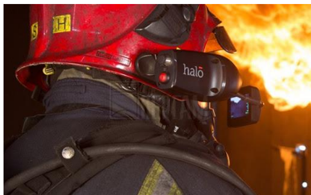
Рисунок 4 – Тепловізійна hands-free камера
