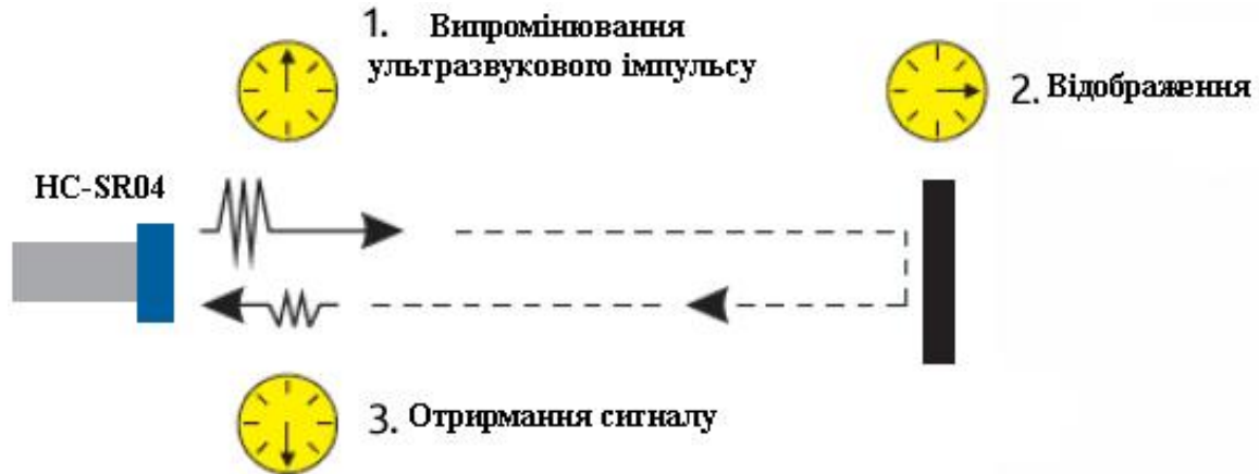
Рисунок 5 – Принцип роботи ультразвукового датчика відстані
