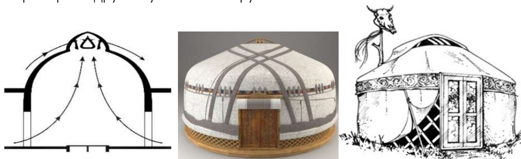
Рис.15. Применение «Эффекта Бернулли» в народной архитектуре.
