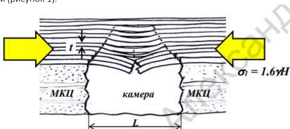
Рисунок 1 – Характерная форма обрушений кровли очистных камер
