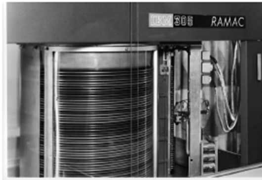
Şəkil 7.3. IBM 305 RAMAC sərt diski
