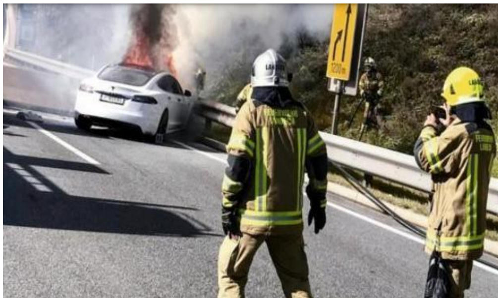
Рисунок 5 – Пожежа автомобіля від короткого замикання літій-іонної батареї
