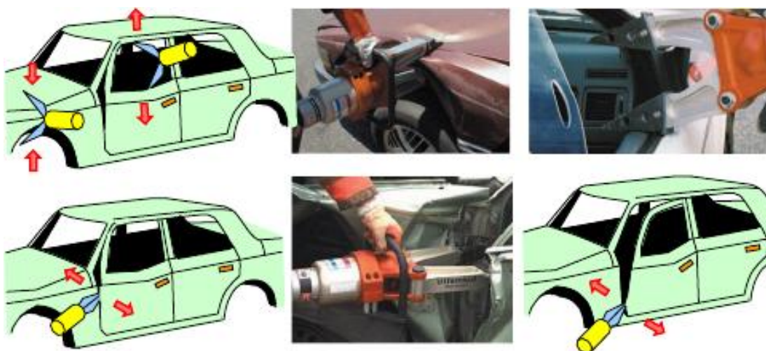
Рисунок 2 – Варіант технології видалення передніх дверей
