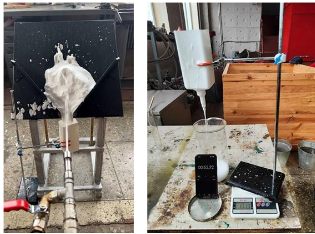
Рисунок 2 – Фото процесу дослідження: а – подавання компресійної піни на стенд; б – вимірювання кратності та стійкості компресійної піни.
