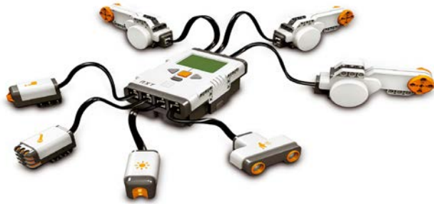
Рис. 2 – Мікропроцесорний блок Lego NXT
