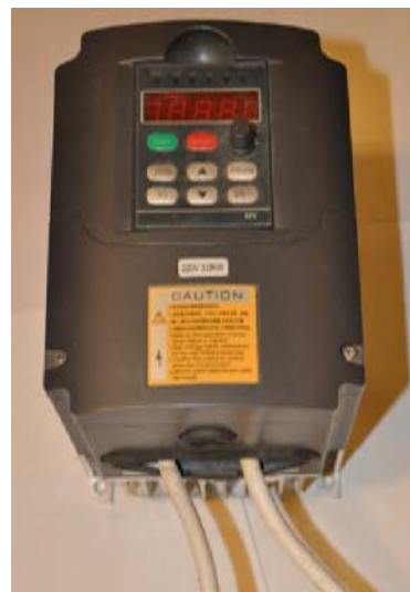
Рис. 11 – Інвертор для керування шпинделем
