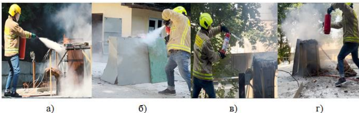
Рисунок 1 – Використання різних типів переносних вогнегасників під час гасіння літій-іонного модуля: а) ВП-5 (з); б) ВВК-5; в) ВВП-5 (з) ; г) ВВ-5 (з)
