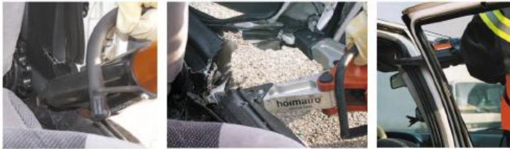
Рис. 7. Технологія перекушування середньої стійки
