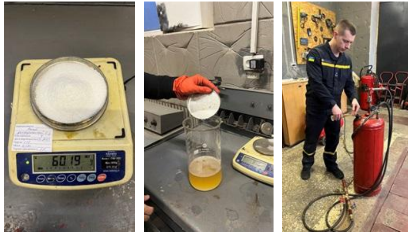
Рисунок 1 – Процес приготування розчину: а – контрольне зважування модифікованих добавок; б – приготування розчину піноутворювача із модифікованими добавками в заданих пропорціях; в – заповнення ємності системи генерування та подавання компресійної піни.
