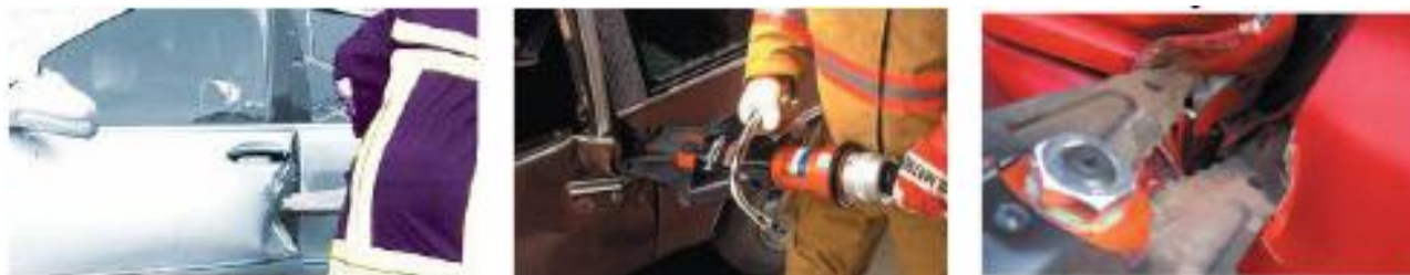
Рисунок 1 – Варіант технології відчинення заклинених передніх дверей
