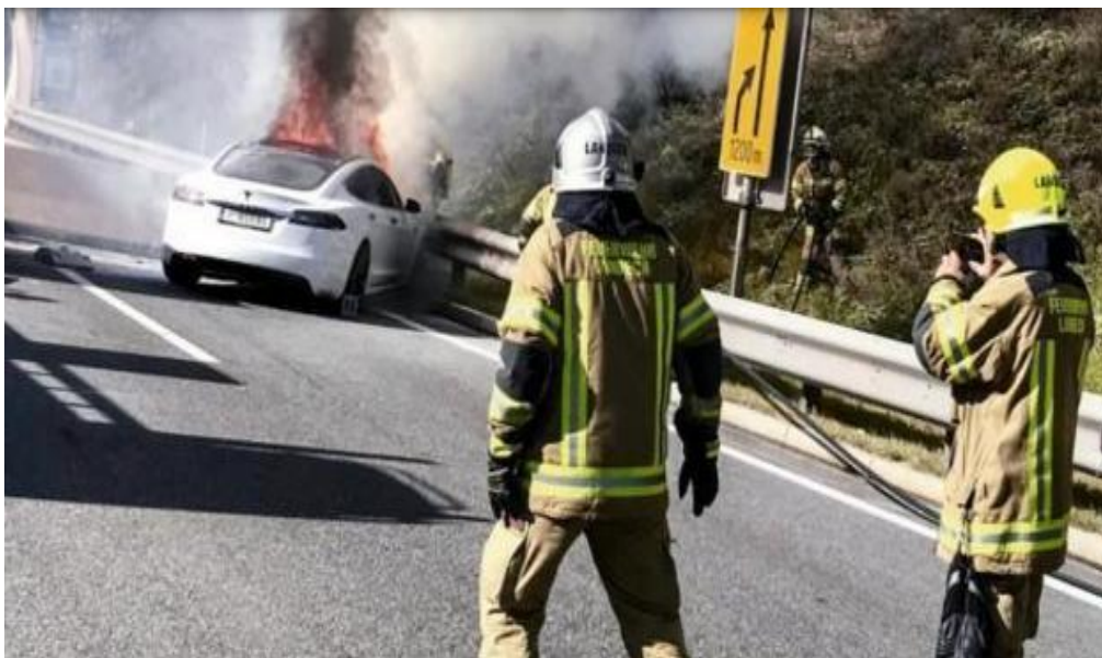
Рисунок 5 – Пожежа автомобіля від короткого замикання літій-іонної батареї
