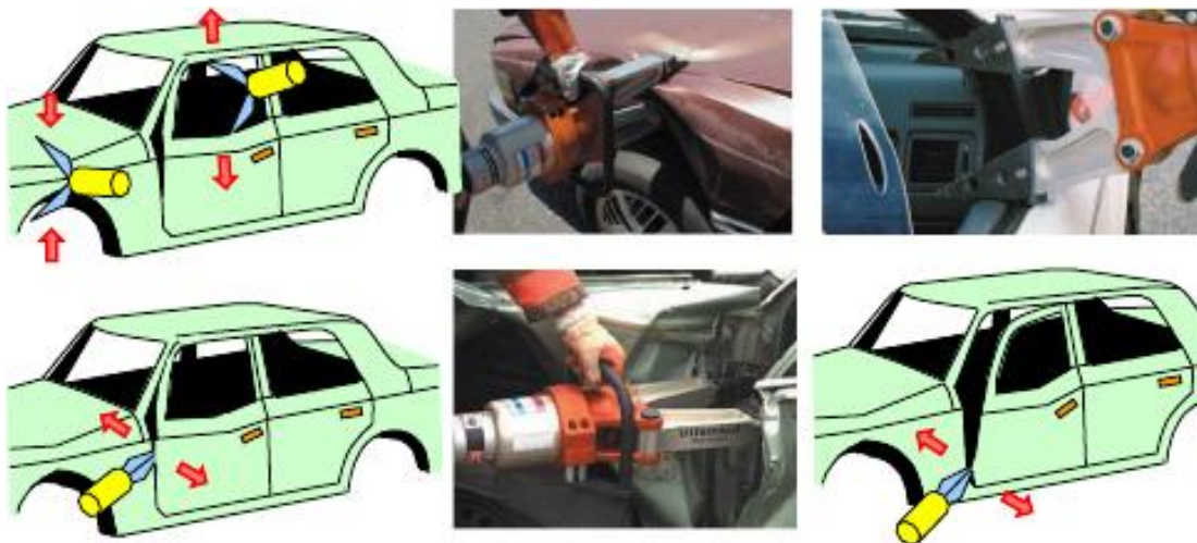
Рисунок 2 – Варіант технології видалення передніх дверей
