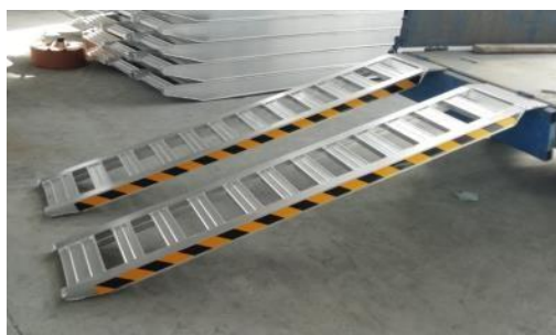
Рисунок 2. Комплектація до причепа для транспортування тактичних роботів пожежогасіння: а) алюмінієві пандуси; б) врізні кільця кріплення вантажу.
