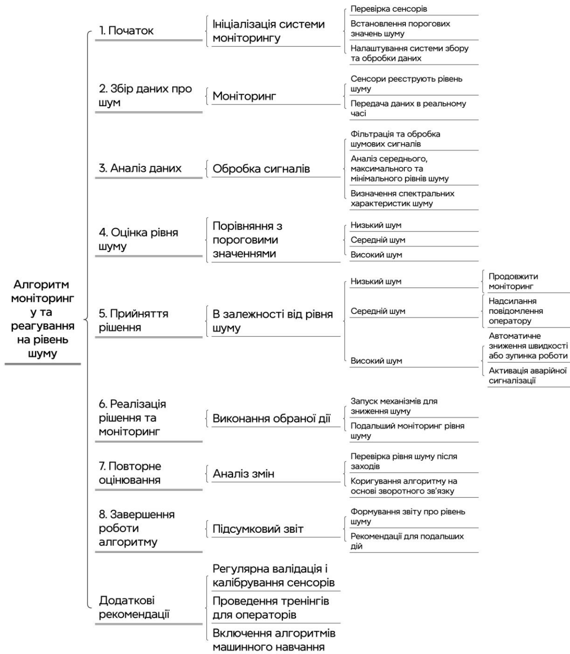
Рисунок 1 – Моніторинг та реагування на рівень шуму дорожньо-будівельних машин
