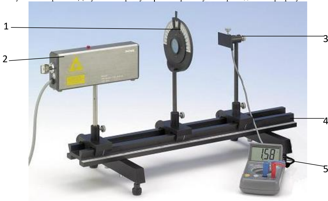
Рис. 1. Експериментальна установка для перевірки закону Малюса: 1 - поляризаційний фільтр, 2 - лазер, 3 - фотоеlement, 4 - оптична лава, 5 - цифровий мультиметр.
