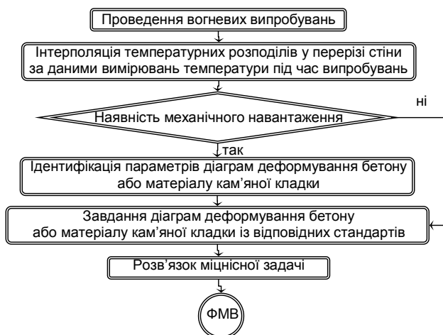
Рисунок. 1 – Схема здійснення оцінки вогнестійкості за допомогою інтерпретації результатів вогневих випробувань залізобетонних несучих стін.
