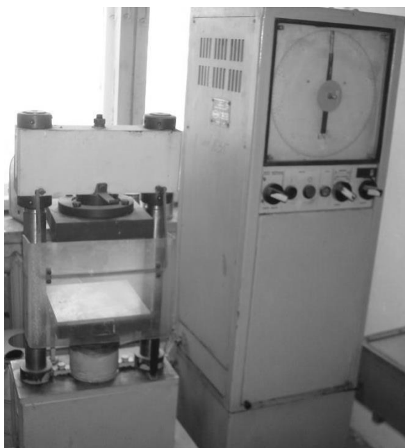
Рис. 4.1. Зовнішній вигляд гідравлічного пресу МС-1000 для випробувань на стискання
