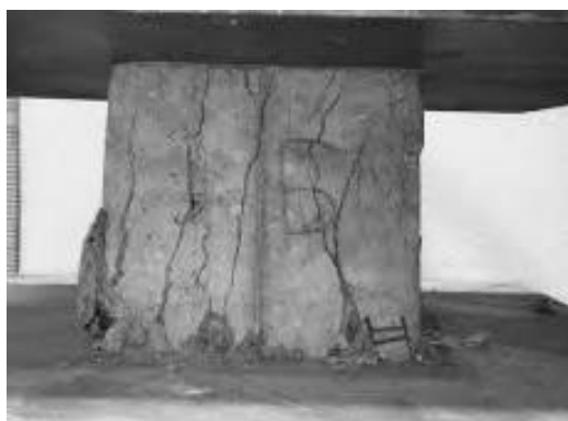
Рис. 4.3. Вигляд кубічного бетонного зразку після випробувань на міцність.
