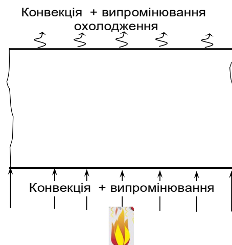
Рис. 2.4. Схема теплового впливу на сталезалізобетонну плити.
