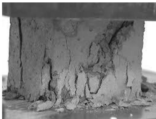
Рис. 4.3. Вигляд кубічного бетонного зразку після випробувань на міцність.
