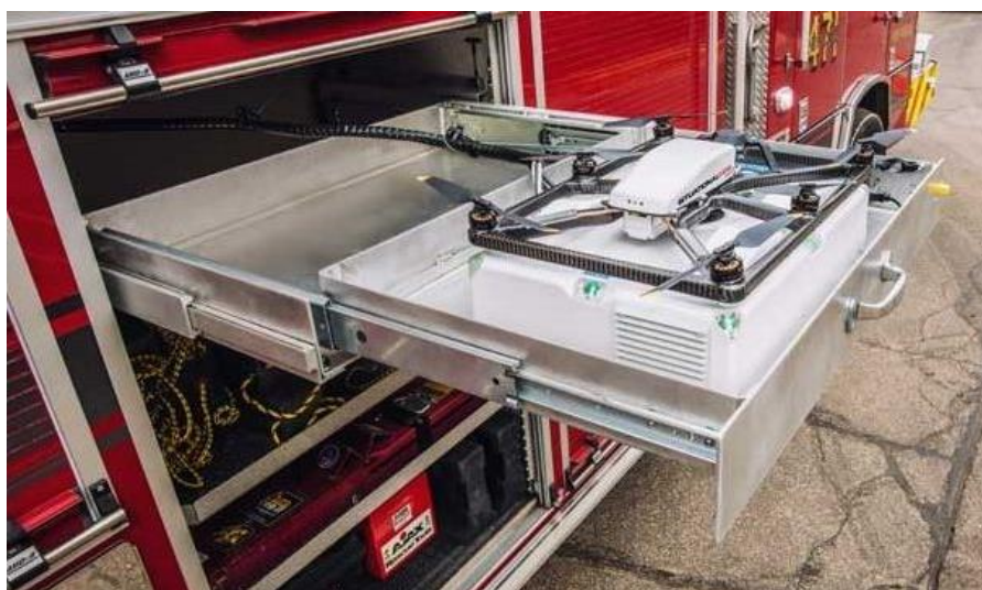
Рис. 1 – Вигляд БПЛА Pierce Fotokite в транспортному положенні
