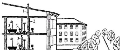
Рисунок 8.1 – Схема внутрішньої каналізації житлової будівлі
