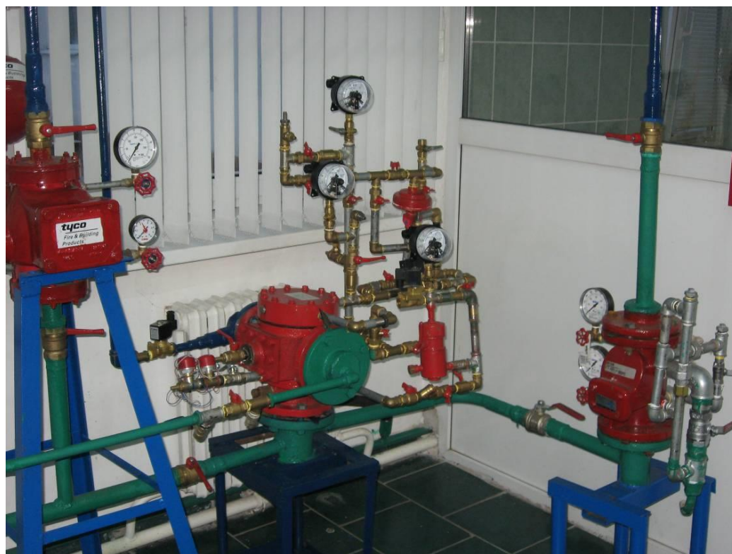
Рисунок – 2. Внешний вид узла управления экспериментальной установки автоматического водяного пожаротушения
