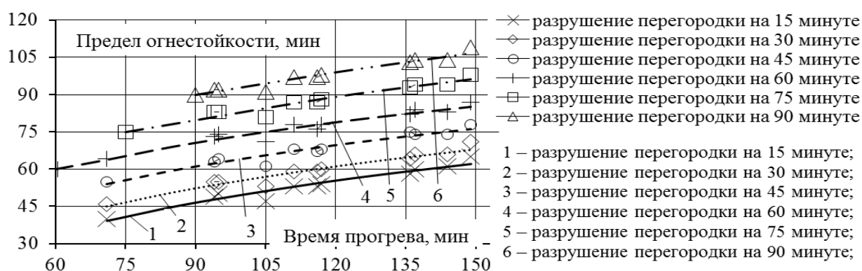
Рисунок – 3. Зависимость коэффициента ускорения прогрева k_a от времени прогрева целостной конструкции при двухстороннем огневом воздействии и предела огнестойкости ограждающей конструкции
