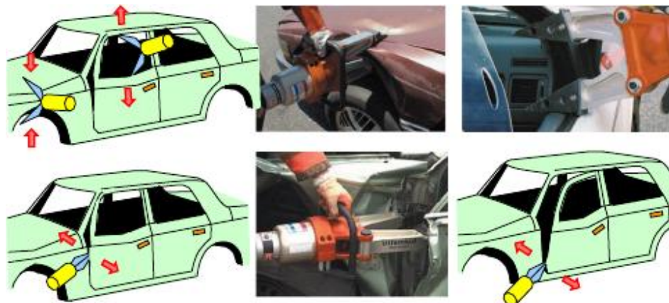
Рисунок 2 – Варіант технології видалення передніх дверей
