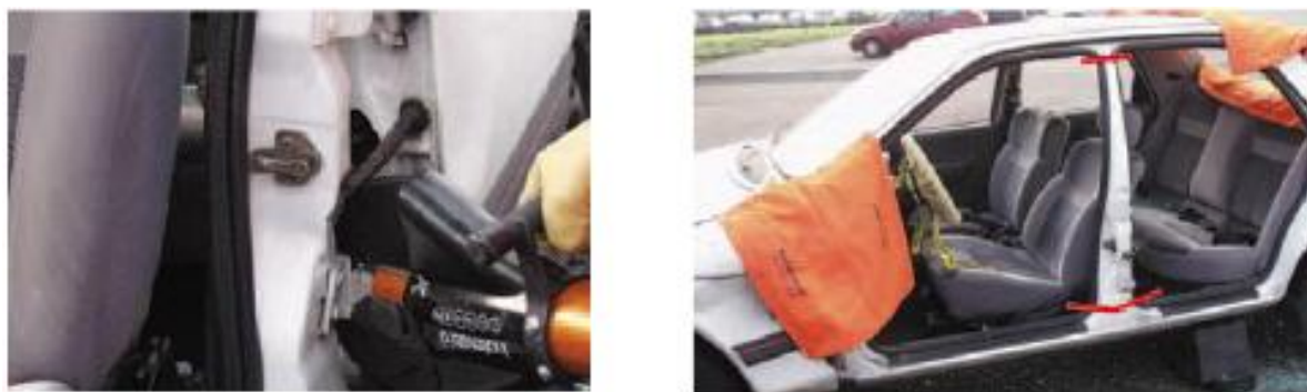
Рисунок 3 – Варіант технології демонтажу бокової сторони ТЗ
