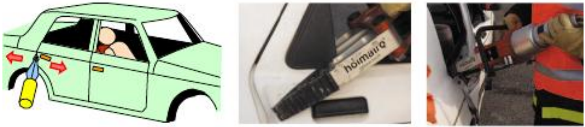
Рисунок 5 – Варіант технології відкривання задніх дверей
