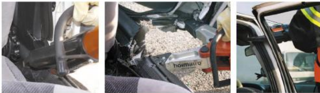
Рисунок 7 – Технологія перекушування середньої стійки
