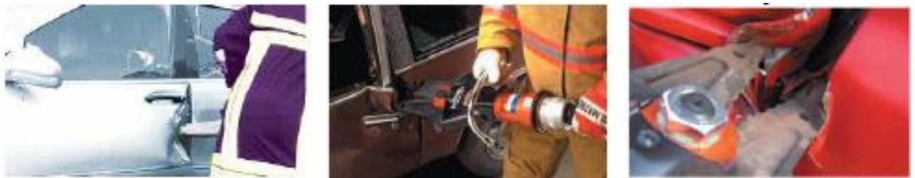
Рисунок 1 – Варіант технології відчинення заклинених передніх дверей
