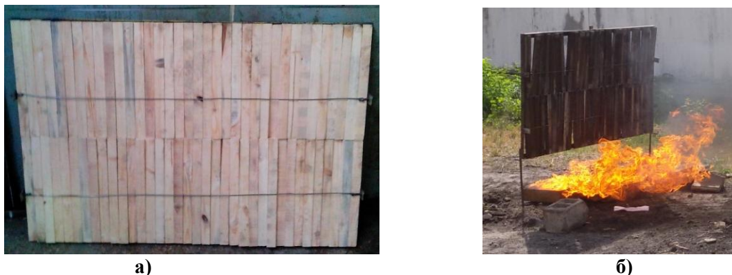
Рис. 2. Забезпечення експериментів по гасінню модельних вогнищ класу 1А: а – наближений за своїм пожежним навантаженням фрагмент підлоги вагону метро; б – розпалювання модельного вогнища у вигляді фрагменту підлоги вагону
