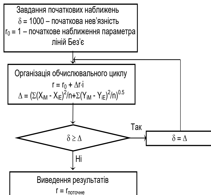
Рисунок 1 – Блок-схема алгоритму визначення параметру r для наближення ізотерм із критичною температурою \theta_{кр} = 200 °С лініями Безьє
