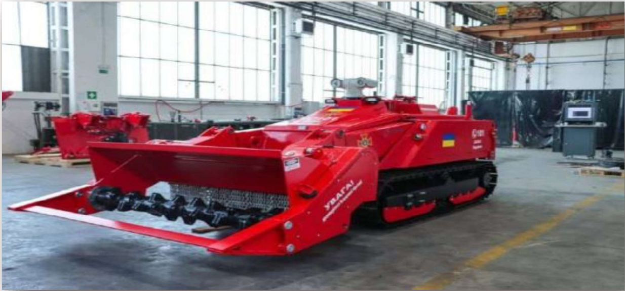
Рисунок 4 – Машина механізованого розмінування DOK-ING MV-10.
