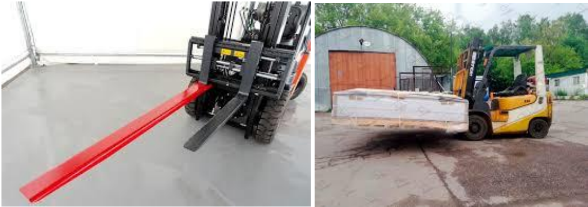
Рисунок 1 – Порівняльний вигляд вил і розташування вантажу на вилах з подовжувачем
