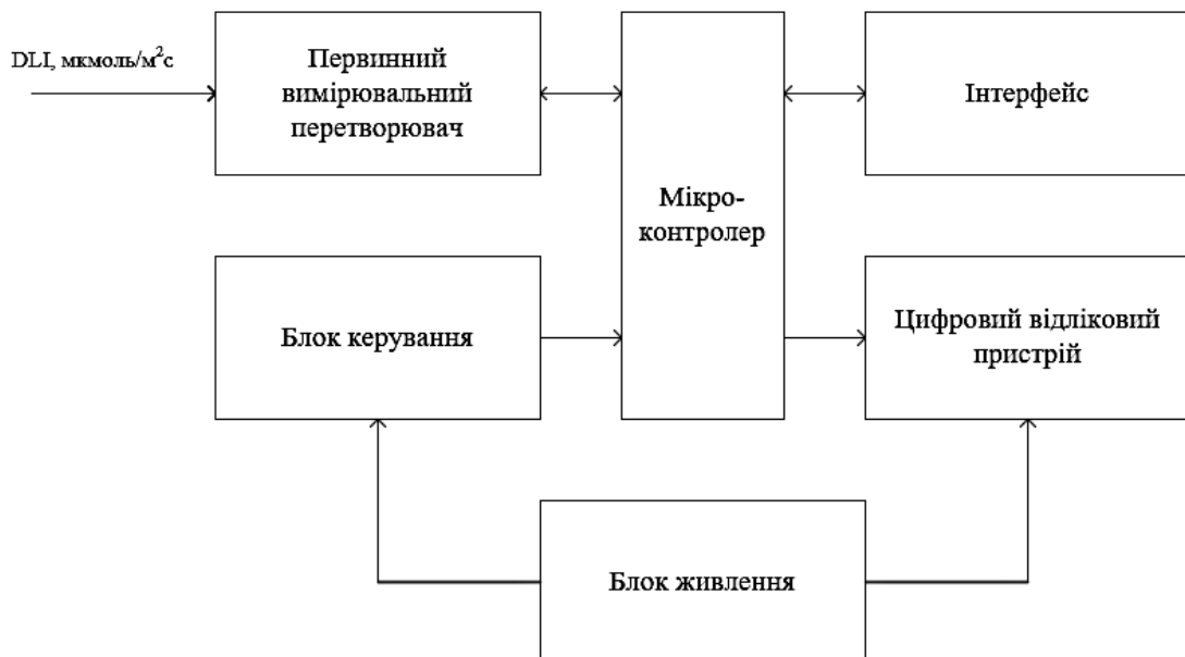
Рисунок 1 – Структурна схема цифрового люксометра
