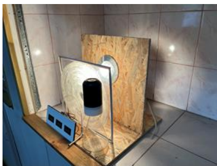
Рис. 1. Макет установки для дослідження властивостей теплоємності води
