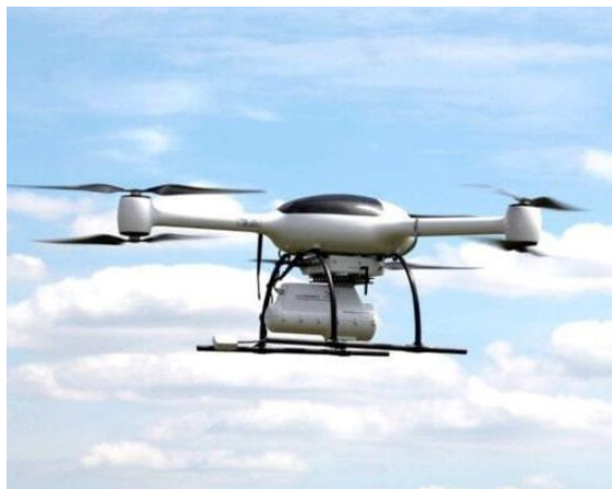
Рис. 2 – БПЛА BRUS для вимірювання рівня радіації
