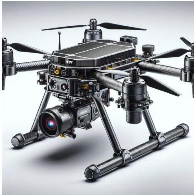
Рис.1 – Проект БПЛА оснащений тепловізійним сенсором FLIR, лідаром Velodyne, мультиспектральним сенсором VicaSense, сенсором якості повітря Aeroqual на карбоново-полімерній рамі посиленій вуглецевими волокнами
