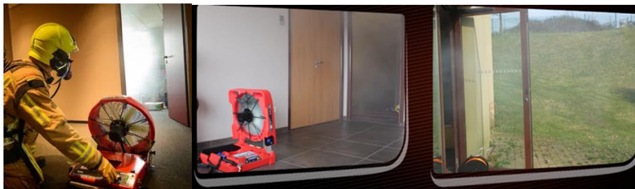
Рисунок 4 – Нагнітання свіжого повітря в задимлене приміщення
