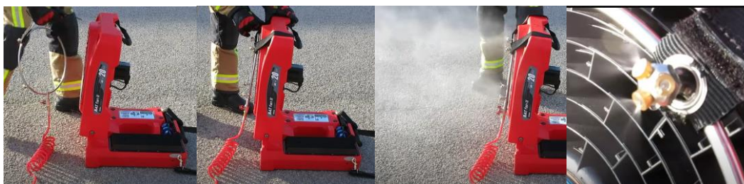
Рисунок 7 – Подача дрібнорозпиленого стуменя води для осадження хмари НХР
