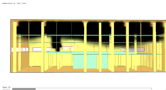
Рисунок 4 – Візуалізація розповсюдження небезпечних чинників пожежі в машинному залі АЕС.
