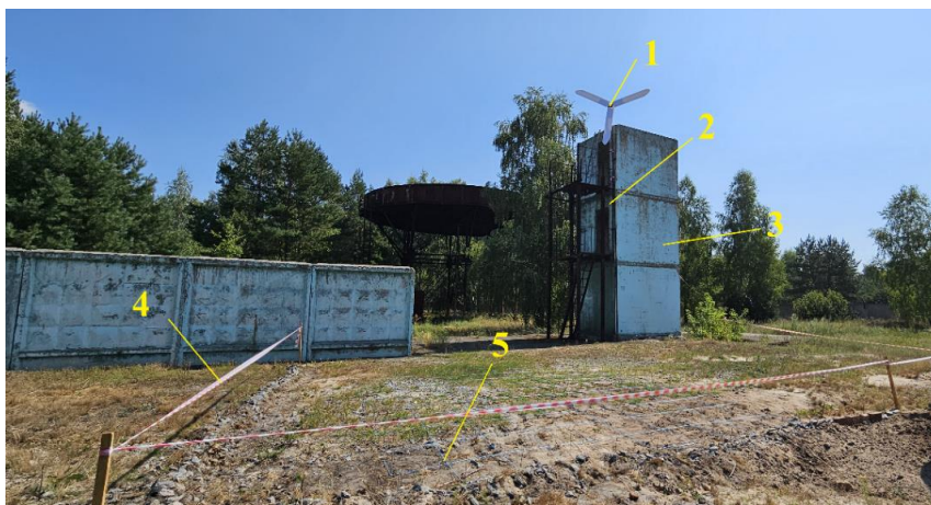
Рисунок 1 – Зовнішній вигляд випробувального вогневого майданчику, де: 1 – вітрова електроустановка; 2 – вежа, яка тримає гондолу; 3 – допоміжна споруда операторів досліджень; 4 – межа вогневого майданчику; 5 – маркерна сітка для фіксації площі розливу мастила
