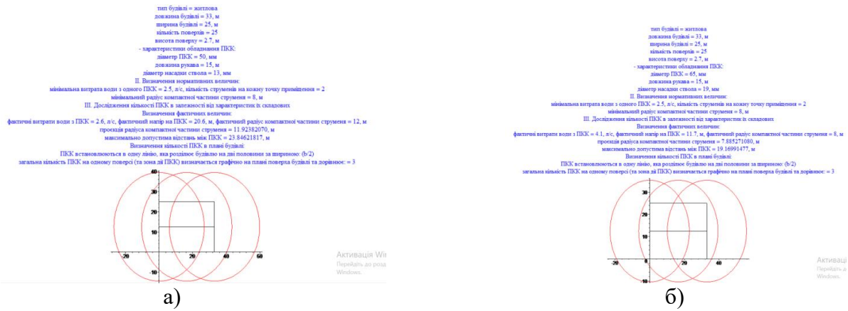
Рисунок 1 – Розрахунок кількості ПКК у житловій будівлі для рукавів довжиною 15 м та ПКК діаметром: а) 50 мм; б) 65 мм
