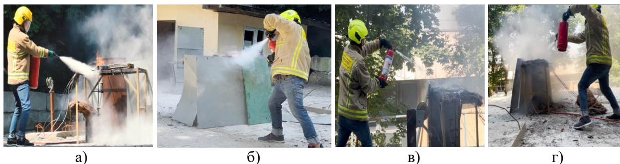
Рисунок 2 – Використання різних типів переносних вогнегасників під час гасіння літій-іонного модуля: а) ВП-5(з); б) BVK-5; в) VVP-5(з); г) BB-5(з)
