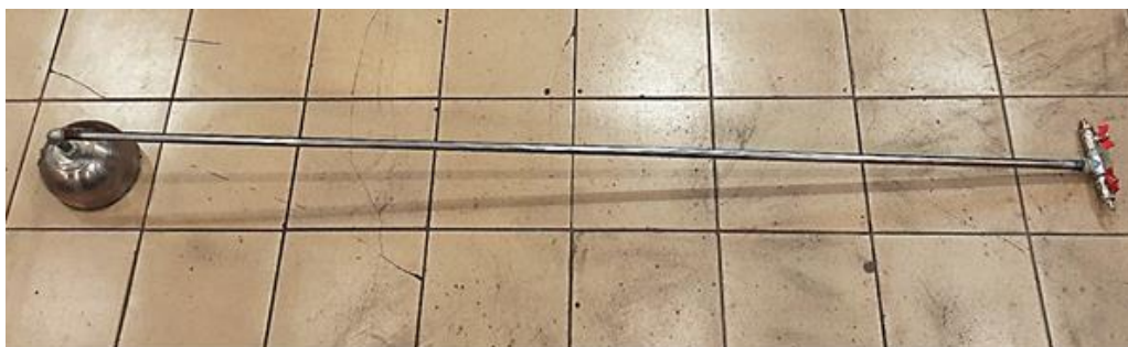
Рисунок 1 – Загальний вигляд насадки «заспокоювача» та труби-подовжувача із запірними вентиллями
