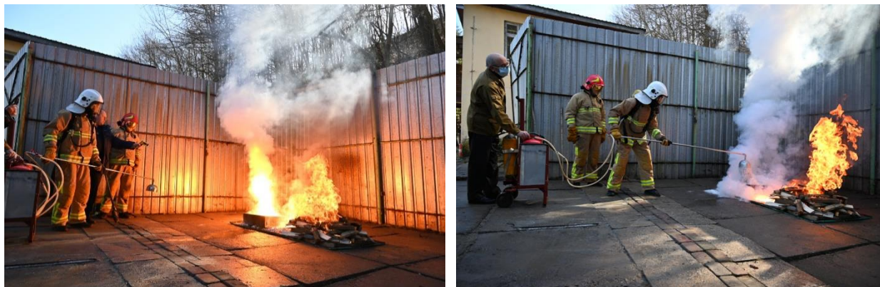
Рисунок 2 – Гасіння комбінованої пожежі деревини і магнію після подавання порошку піною підвищеної стійкості
