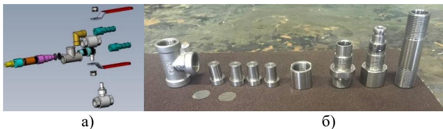
Рисунок 3 – Елементи розробленого ствола: а) елементи у 3D-виді; б) фото виготовлених деталей
