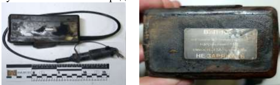
Рисунок 2 – Блок живлення - нерозбірна літєва батарея ВИП-1013 (зразок 2)
