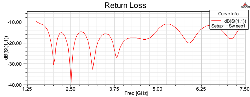
Рисунок 2 – Частотна залежність коефіцієнту відбивання LPDA-антени (коефіцієнту матриці розсіювання S11)
