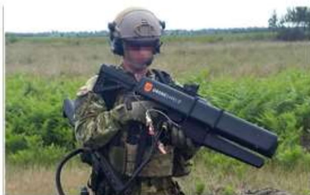
Рисунок 3. Багатопроменева антидронна рушниця.
