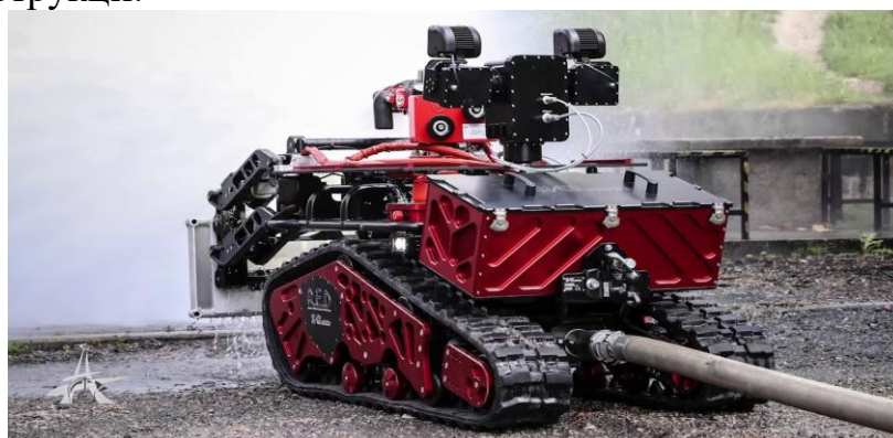
Рисунок 2 – Використання французького робота Colossus під час гасіння в Соборі Нотр-Дам, Париж, Франція.
