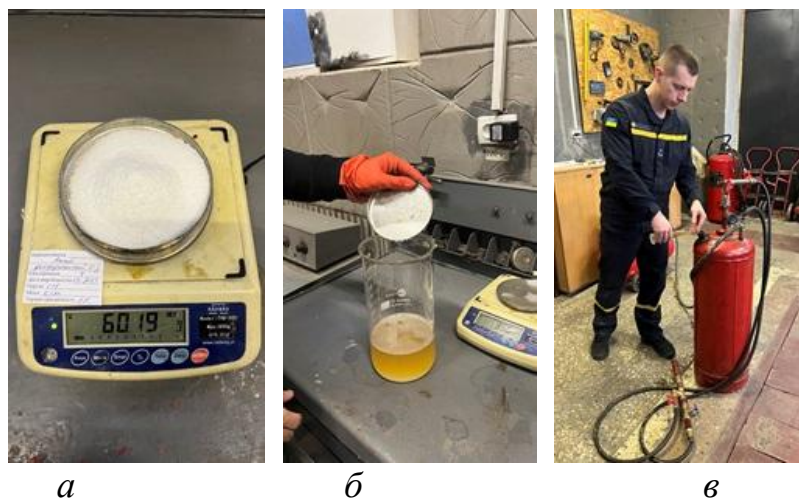
Рисунок 1 – Процес приготування розчину: а – контрольне зважування модифікованих добавок; б – приготування розчину піноутворювача із модифікованими добавками в заданих пропорціях; в – заповнення ємності системи генерування та подавання компресійної піни.
