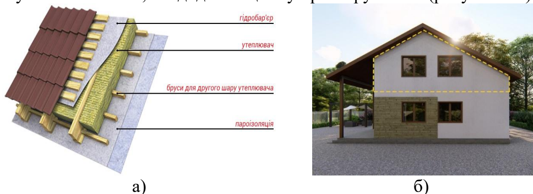
Рисунок 1 – Мансардне приміщення у житловому секторі: а) будова покрівлі мансардного приміщення б) загальний вигляд мансардного приміщення
