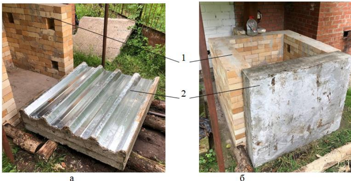
Рисунок 1 – Фрагмент сталезалізобетонної плити з гофрованим профілем, виготовленої заздалегідь до випробування: 1 – огороження малогабаритної вогневої печі; 2 – фрагмент сталезалізобетонної плити для випробування
