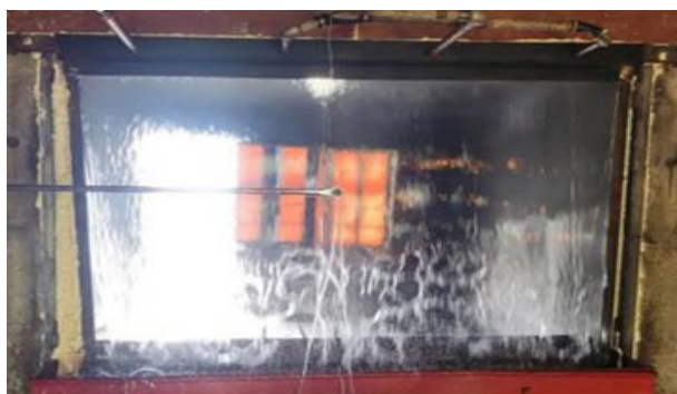
Рисунок 1 – Загальний вигляд водяної завіси у вигляді суцільного потоку
