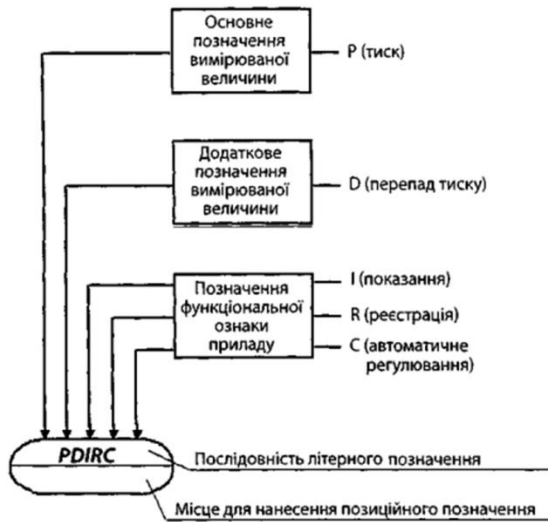
Рис. 7.2 – Принцип побудови умовного зображення приладу автоматики
