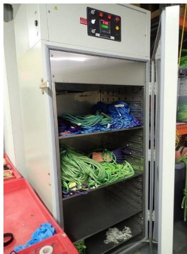
Рисунок 2. Камера кондиціонування випробувальних зразків компанії Sterling Rope
