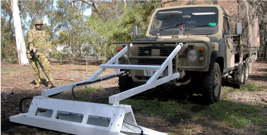
Рис. 1 – Детектор металу Minelab STMR Array підвішена на шарнірній опорній конструкції перед транспортним засобом
