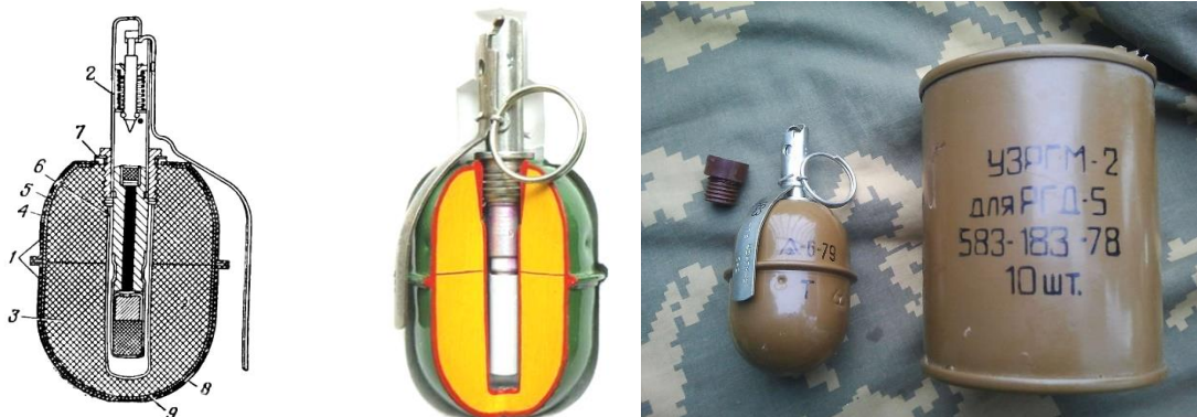
Рис. 1. Будова осколкової ручної гранати дистанційної РГД5 (57Г717): 1 – корпус; 2 – УЗРГМ2; 3 – розривний заряд ( T = 0,110 кг); 4 – ковпак; 5 – вкладень ковпака; 6 – трубка для запалу; 7 – манжета; 8 – піддон; 9 – вкладень піддону
