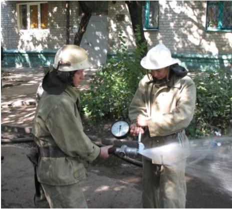
Рисунок 8.6 – Використання трубки Піто для визначення кількості води
