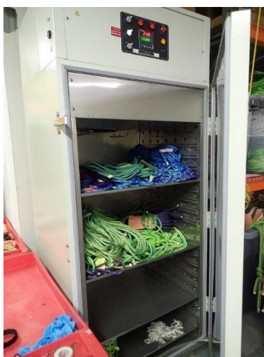
Рисунок 2. Камера кондиціонування випробувальних зразків компанії Sterling Rope
