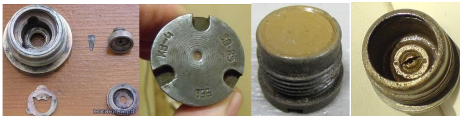
Рис. 1 – Капсульна втулка четвертого зразка КВ-4 (54-В-024): (діаметр різьби \varnothing 27 мм; 558 – завод-виробник; 50 – номер партії; 85 – рік виготовлення)
